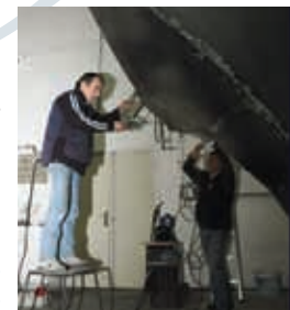
Fabrication de l'étrave de la maquette dans les ateliers de la Ville de Paris
